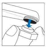
Entfernen des Adapters: Mit Sechskant-Seite des Montage-Schlüssel aus dem Hahn herausschrauben.
