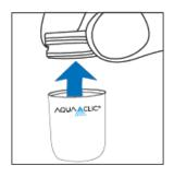
Bei Bedarf (für Hahn mit Aussengewinde) Adapter wegschrauben.
